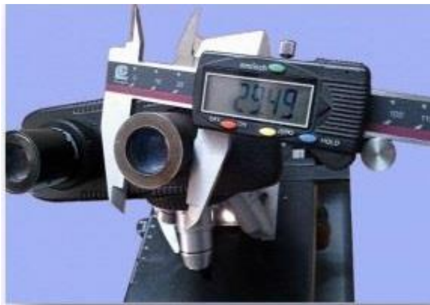
اندازه گیری قطر لنز چشمی با کولیس
