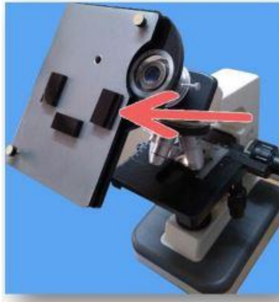
نحوه قرار گرفتن آهنرباها بر روی صفحه دستگاه
