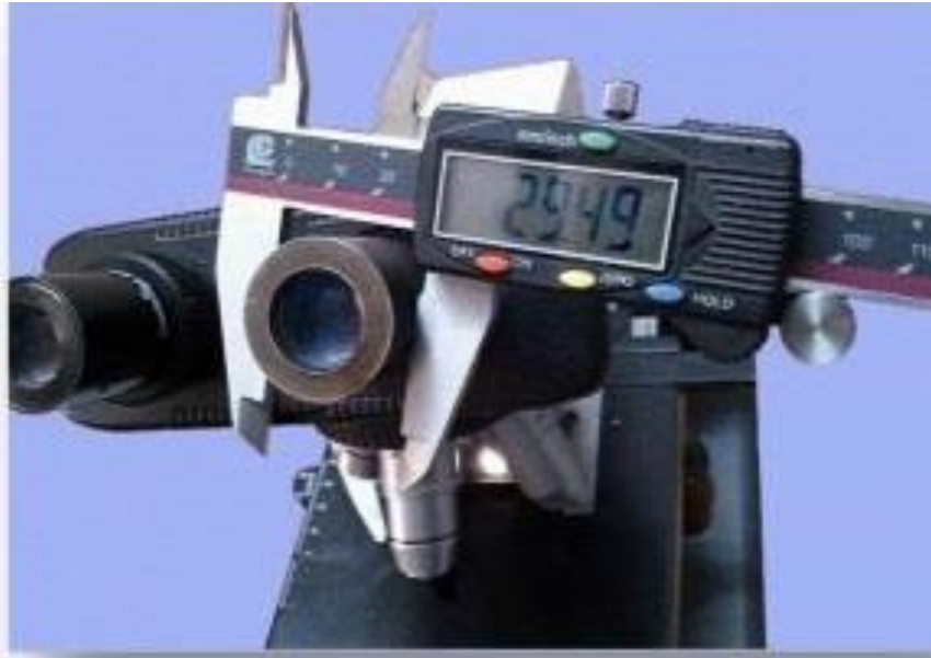
اندازه گیری قطر لنز چشمی با کولیس
