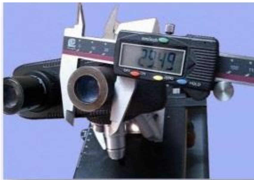
اندازه گیری قطر لنز چشمی با کولیس
